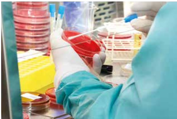
Medizinisch-Technische Laboratoriumsassistent:innen bringen das Probenmaterial auf verschiedenen Nährmedien, sogenannten Agarplatten, auf.
